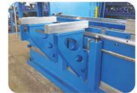
Soportes delanteros resistentes, móviles sobre guías lineales, ajustables en altura (opcional)
