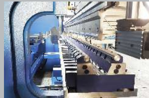
Matriz en V ajustable (V=25-400mm) especialmente diseñada para el servicio pesado.
