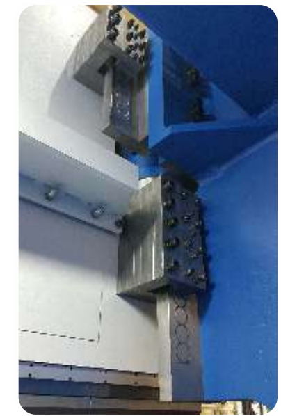
Movimiento de viga en los controles deslizantes de bronce resistentes para garantizar la seguridad y la precisión
