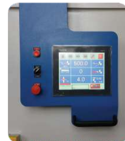
Monitor color táctil de 10,4" móvil a lo largo de toda la máquina (opcional)
