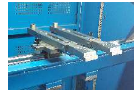
Sujeción Hidráulica Wila con cambio vertical de la herramienta (opcional)
