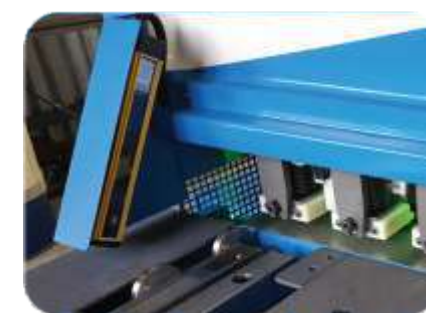
Protección frontal con barrera lumínica (opcional)
