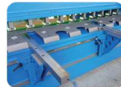
Brazos soporte frontales y móviles a lo largo de toda la máquina (Opcional)
