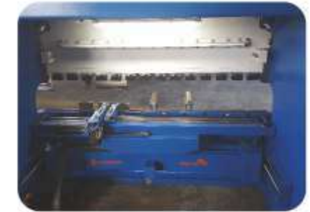
Sistema de guía del tope posterior montado en los lados de la máquina (espacio libre en la parte posterior)
