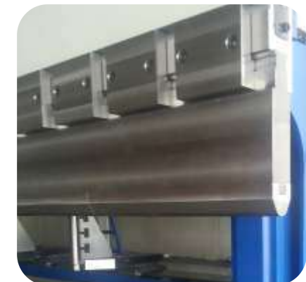
Sistema de agarre para trabajo pesado hasta 350 t/m (opcional)
