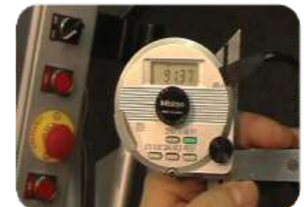
Medición manual del ángulo de flexión y Corrección del programa de doblado (opcional)
