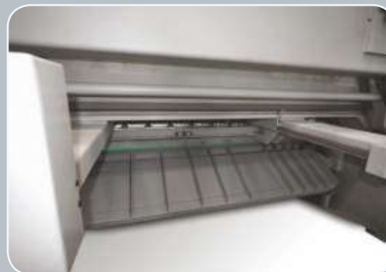
Posición 3: El sistema RSS se vuelve a mover inclinándose, por lo que la hoja de chapa es deslizada afuera de la máquina.
