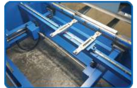
Sistema de tope trasero de 2 ejes, X-R
