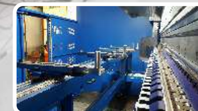
Dedos de tope especiales para espesores finos (opcional)
