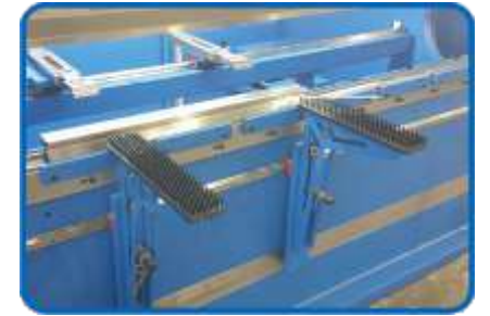
Soporte frontal con cepillos, movibles sobre una guía lineal ajustable
