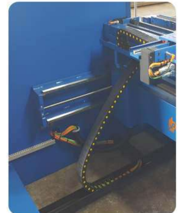
Tope posterior trasero a través de tornillo y tuerca a bolas recirculantes y guías lineales dobles en cada eje.
