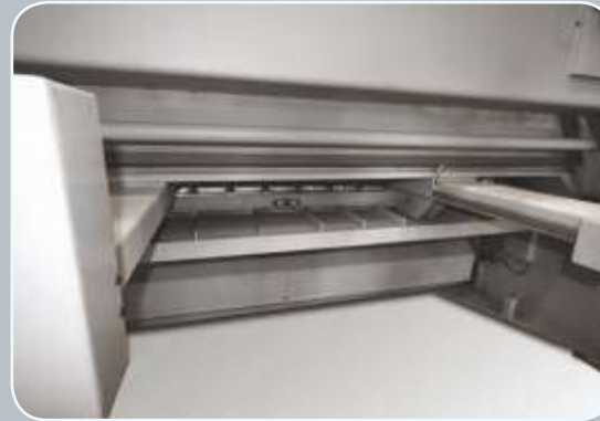
Posición 1: Gracias al sistema RSS, la hoja de chapa es soportada por el tope trasero y no se combe hacia abajo.
