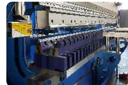
Ajuste de la luz de la V en forma manual, o CNC (opcional)
