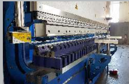
Matriz en V ajustable (V=25-400mm) especialmente diseñada para el servicio pesado.
