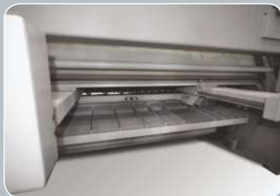
Posición 2: El sistema RSS baja aproximadamente 150mm, para y soporta a la hoja de chapa en toda su longitud no dejando combarse ni tocar el suelo.
